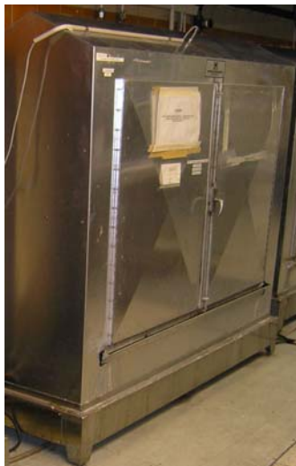
Fig. 1 Example of a tropical cabinet with the exposure chamber dimensions 370x1500x1320 mm Exempel på ett tropikskåp med exponeringskammarens mått 370x1500x1320 mm
